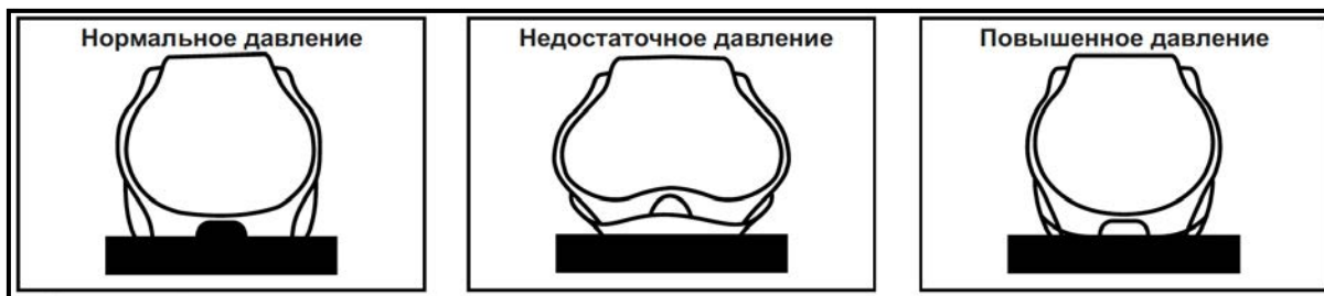
Рис. 4-18. Состояние шин при транспортных работах
