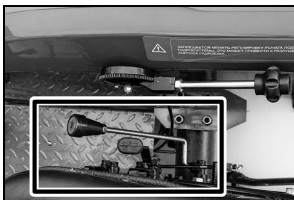
Рис. 4-6. Рычаг управления блокировкой дифференциала
