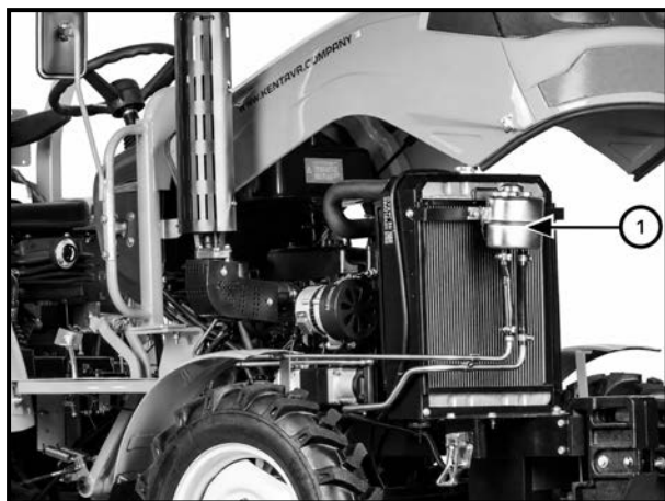
Рис. 5-4. Проверка уровня рабочей жидкости в системе рулевого управления: 1 – бачок гидроусилителя рулевого управления.
