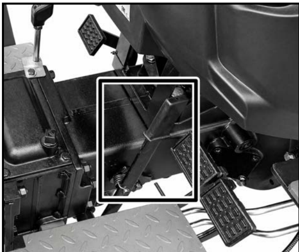
Рис. 4-8. Рычаг включения стояночного тормоза
