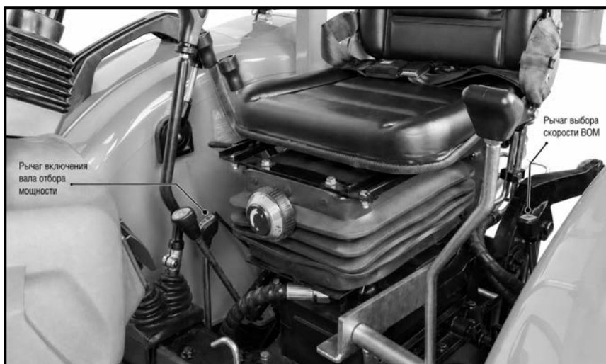
Рис. 3-13. Органы управления валом отбора мощности (BOM) Кентавр Т-254 PRO
