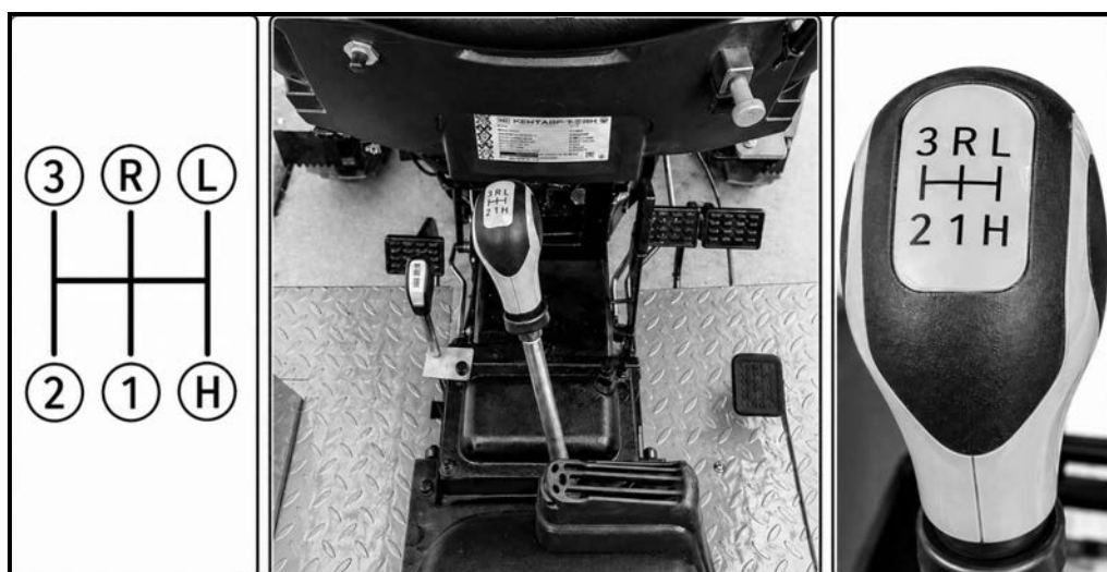
Рис. 4-4. Схема переключения передач, заднего хода и диапазонов трактора Кентавр Т-244 PRO
