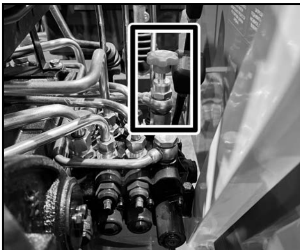
Рис. 4-10. Запорный клапан навески и регулировка скорости опускания
