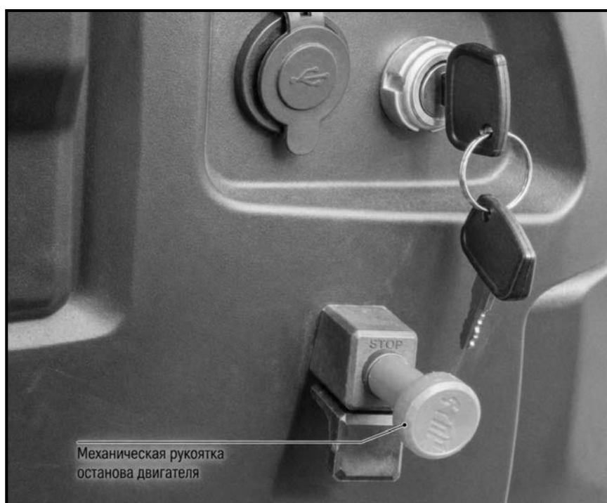
Рис. 3-8. Рукоятка останова двигателя на передней панели
