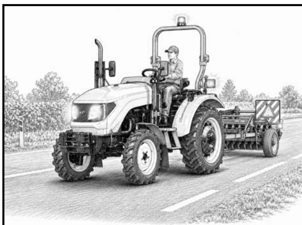
Рис. 2-13. Использование световых приборов и средств обозначения трактора при движении по дорогам общего пользования
