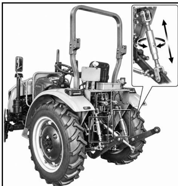
Рис. 4-14. Регулировка подъемного раскоса и выравнивание навесного орудия
