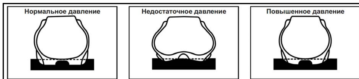
Рис. 4-17. Состояние шин при работе в поле
