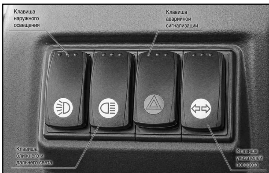
Рис. 3-6. Клавиши управления освещением и сигнализацией на передней панели
