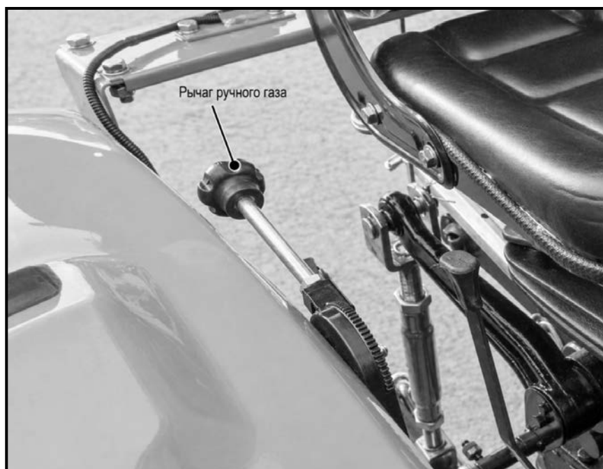
Рис. 3-17. Рычаг ручного газа с сектором фиксации положения
