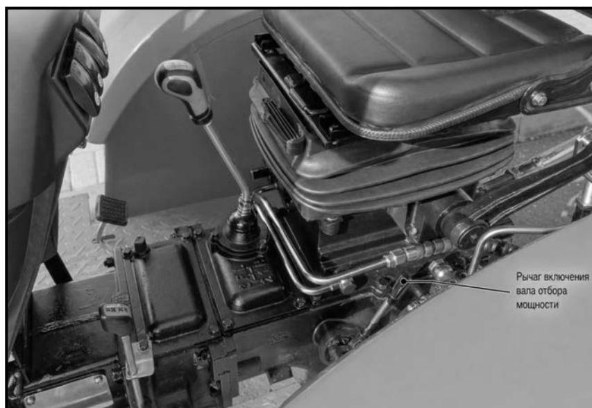
Рис. 3-12. Органы управления валом отбора мощности (ВОМ) Кентавр Т-244 PRO
