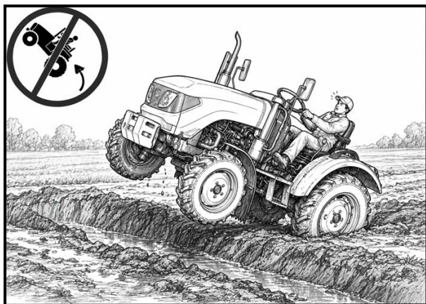
Рис. 2-5. Опасность опрокидывания при попытке резкого выезда
