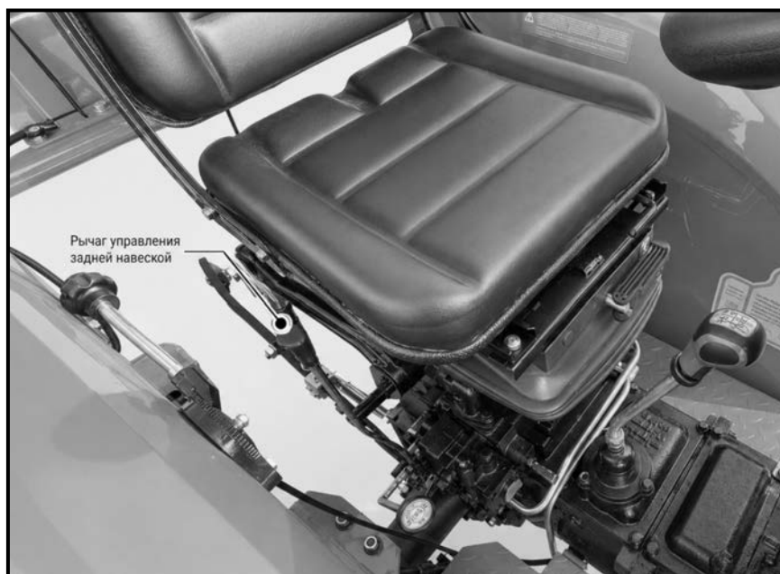
Рис. 3-14. Расположение рычагов управления навеской Кентавр Т-244 PRO
