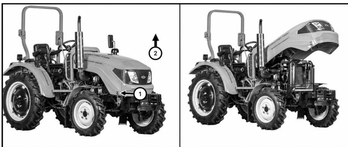
Рис. 5-1. Открытие капота для сервисного доступа
