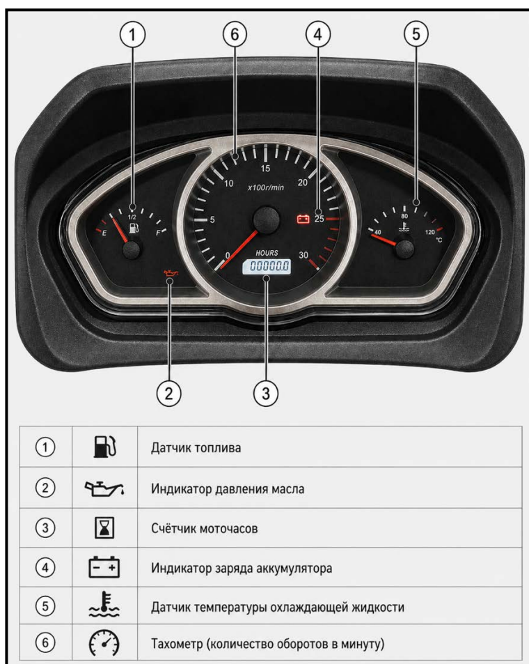
Рис. 3-3. Комбинированная приборная панель трактора Кентавр Т-244 PRO / Т-254 PRO
