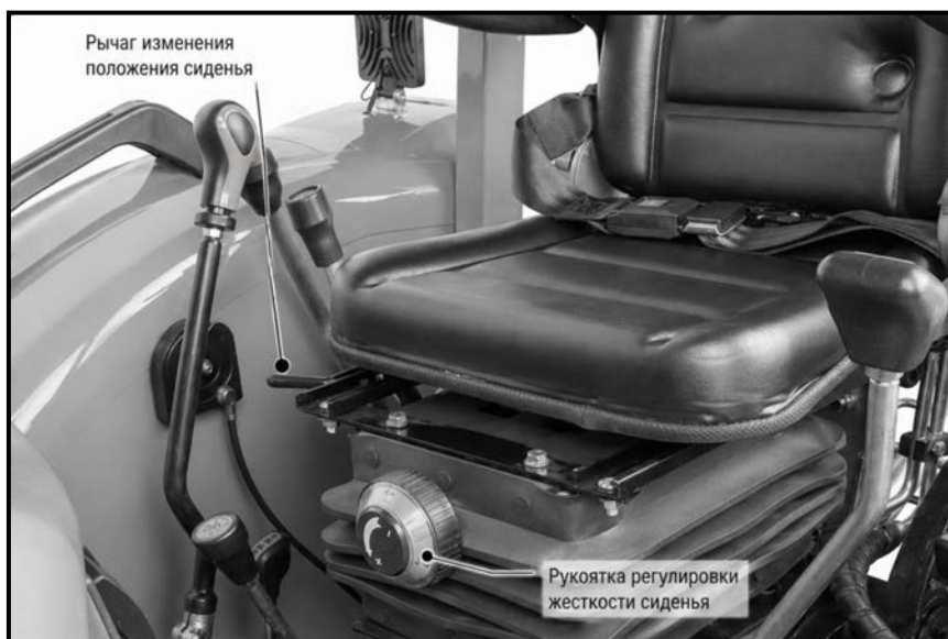
Рис. 3-16. Органы регулировки сиденья оператора
