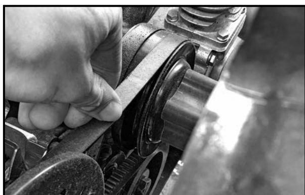
Рис. 5-16. Проверка и регулировка натяжения ремня генератора и вентилятора
