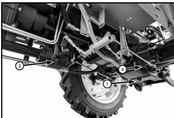
Рис. 5-6. Замена масла в трансмиссии: 1 – сливная пробка корпуса трансмиссии; 2 – сливная пробка раздаточной коробки; 3 – сливная пробка корпуса тормозных механизмов, при наличии.
