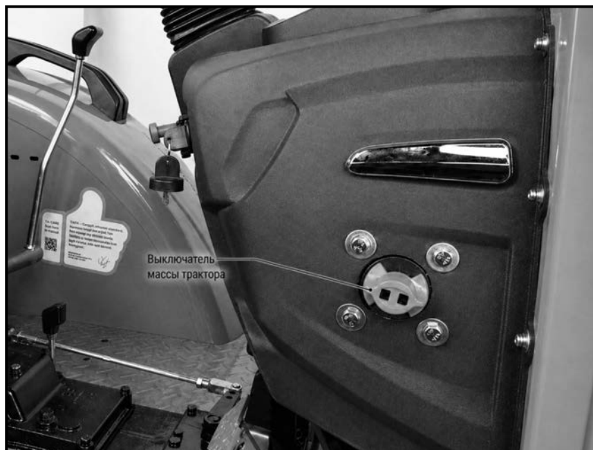
Рис. 3-9. Выключатель массы трактора: вариант установки на передней панели
