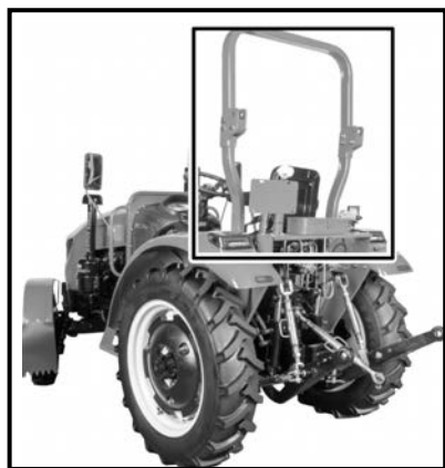
Рис. 4-21. Нормальное рабочее положение дуги безопасности
