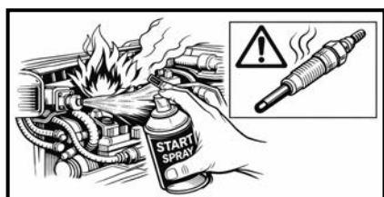
Рис. 2-7. Опасность применения вспомогательной пусковой жидкости при наличии системы предпускового подогрева
