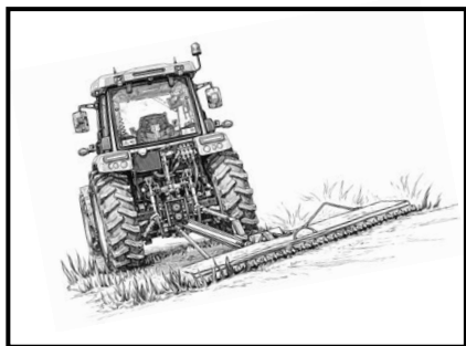
Рис. 2-15. Положение навесного оборудования при движении поперек склона
