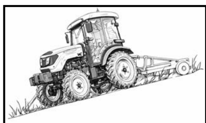
Рис. 2-14. Положение тяжелой части трактора при движении по склону
