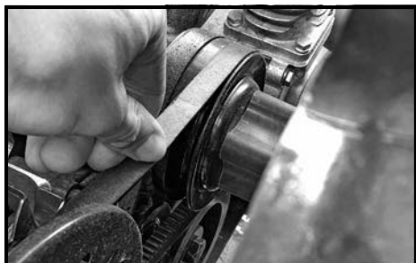
Рис. 5-17. Проверка и регулировка натяжения ремня
