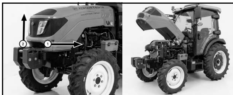
Рис. 5-2. Открытие капота для сервисного доступа
