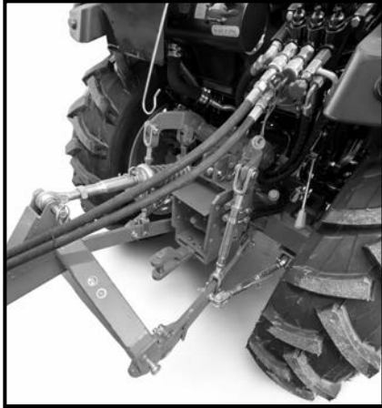
Рис. 4-11. Навешивание орудия на трехточечное устройство
